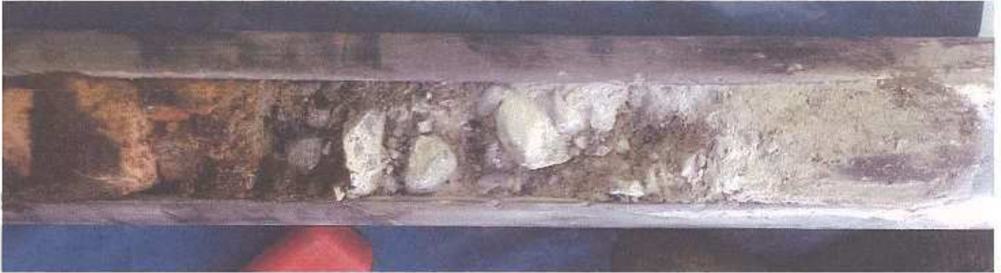
RKS 4, Schlackehaltiges Material 0,5 – 1,0 m
