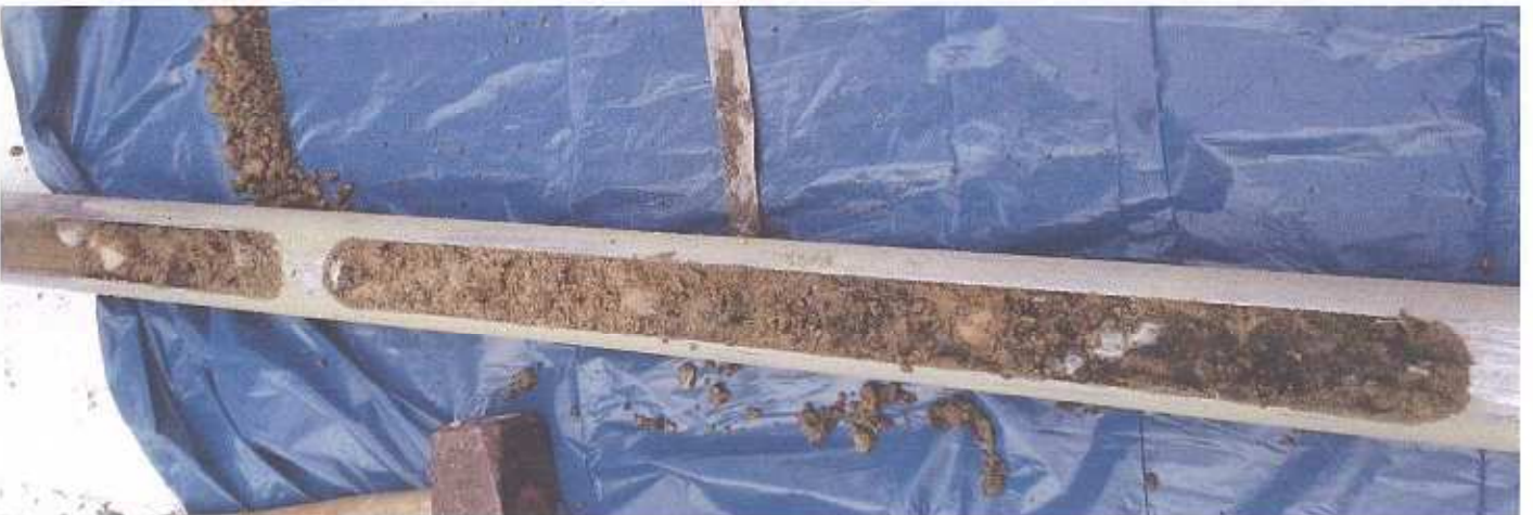
RKS 29: Parkplatz, Tiefenbereich 0 - 1 m, Gebiet alter Bauhof, Tragschicht, darunter ältere Anschüttungen
