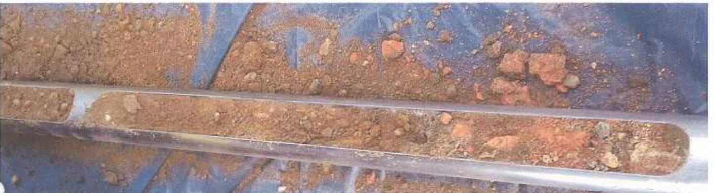
RKS 42: Tiefenbereich 0 - 1 m, Bauschutt
