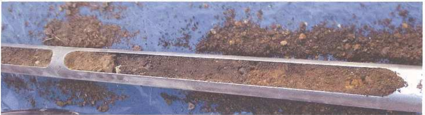
RKS 5: Tiefenzone 0 – 1 m, Auffüllung, Schluff mit Schlackenanteilen
