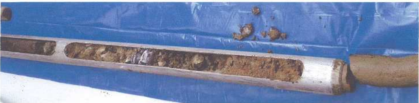
RKS 20: Parkplatz, Tiefenbereich 0 – 1,0 m, Übergang von Unterbau in anstehende Schluffe
