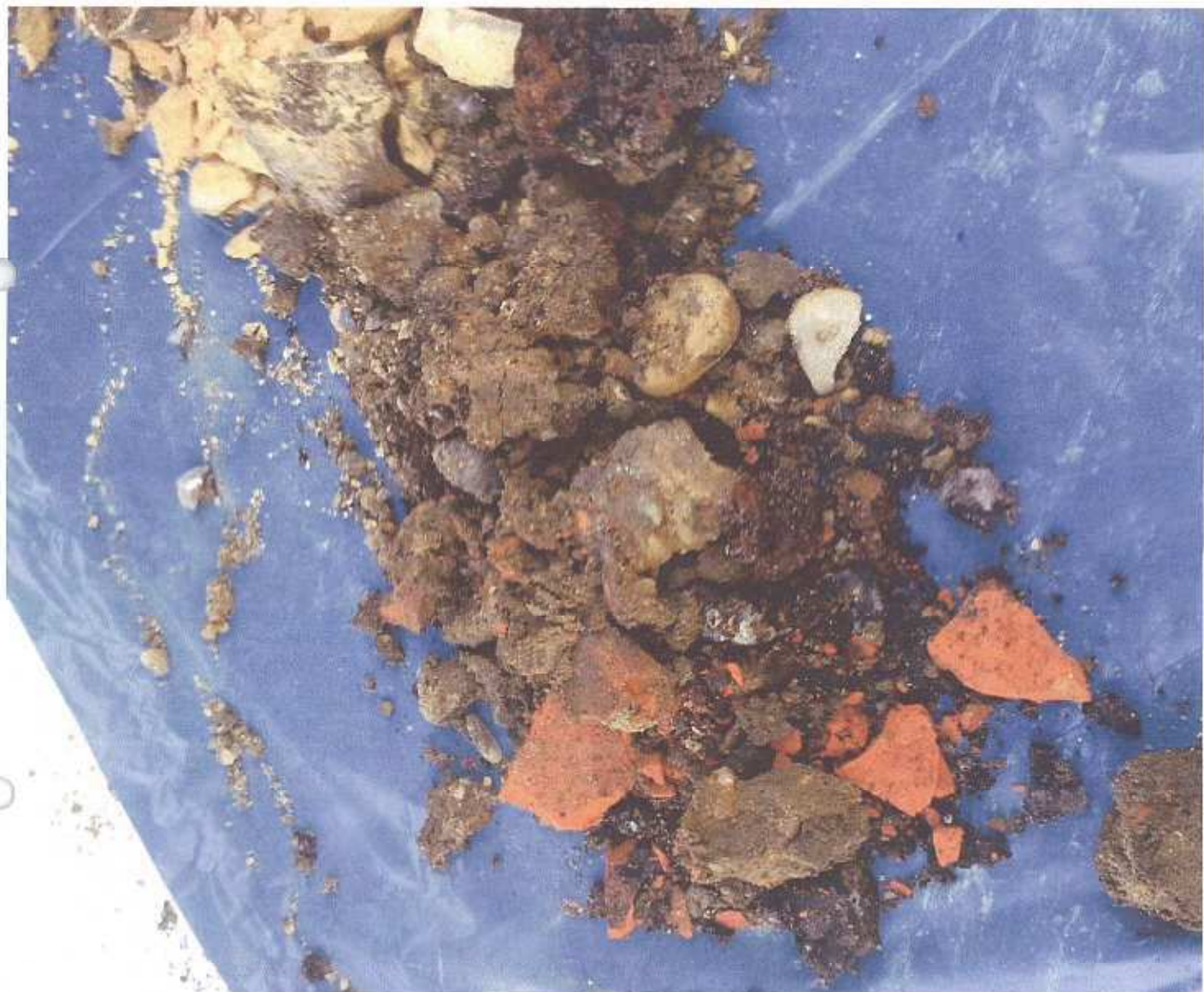
RKS 3: Bohrgut 0,65 – 1,0 m Bauschutt und Schlacken
