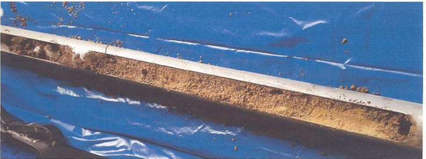
RKS 7: Tiefenzone 0 – 1 m, Auffüllung und unterlagernde Sande
