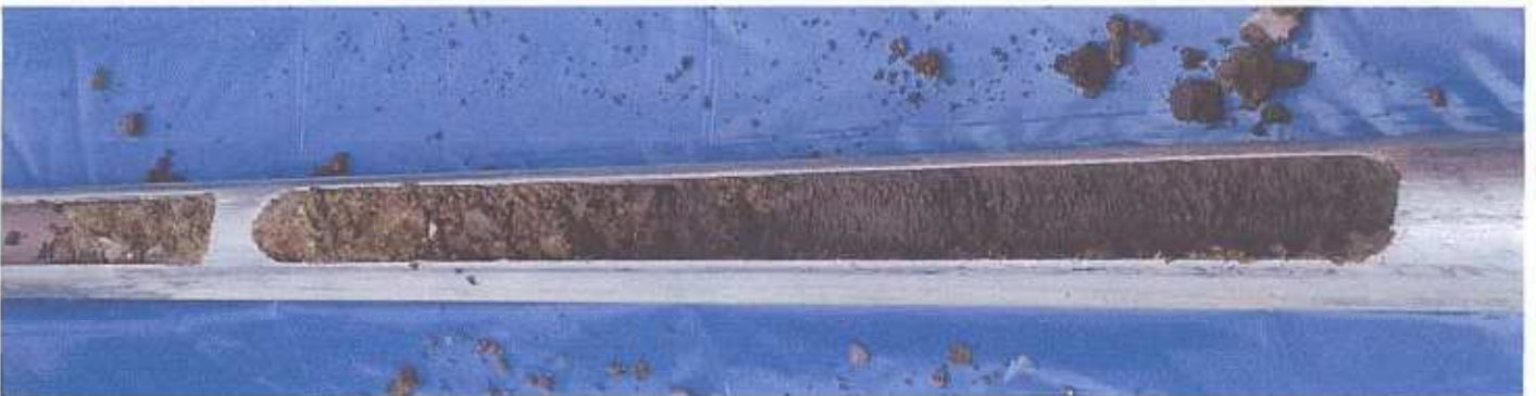
RKS 26: Parkplatz, Tiefenbereich 0 - 1 m, Übergang Unterbau in schluffige Aueablagerungen
